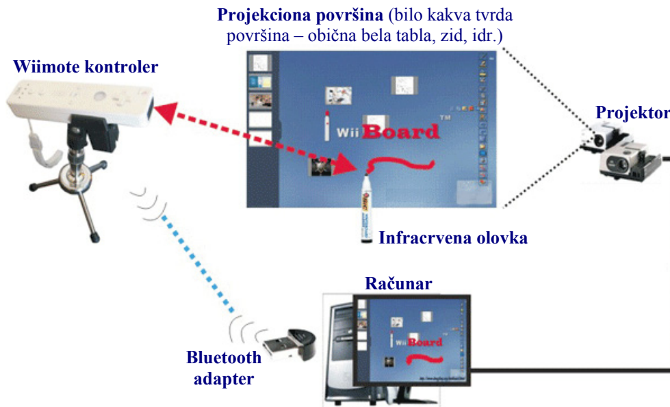
Slika 3: Princip rada Wiimote interaktivne table
