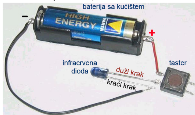
Slika 4: Elementi potrebni za formiranje strujnog kola infracrvene olovke
